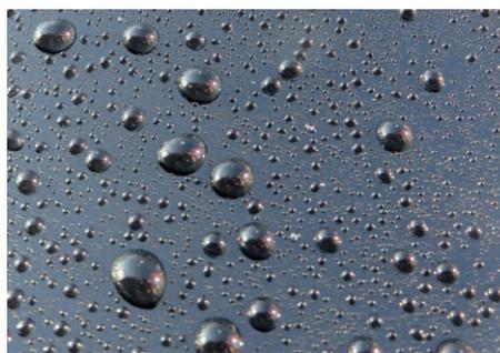
**Abb. 2** Mit einem Lackkonservierer behandelte Lackoberfläche, an der Wassertropfen abperlen.
