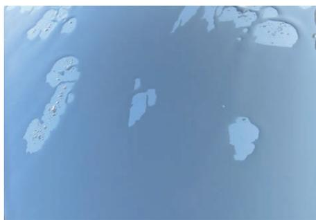
**Abb. 1** Neuwertige, vorbehandelte Lackoberfläche, mit Wasserfilm benetzt.
