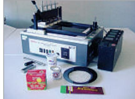
**Abb. 3** Geräte zur Prüfung der Reinigungsleistung.
